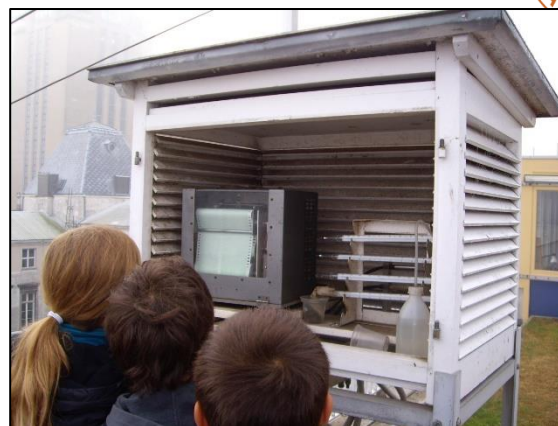
Afbeelding 41: de thermometerhut van ons weerstation
