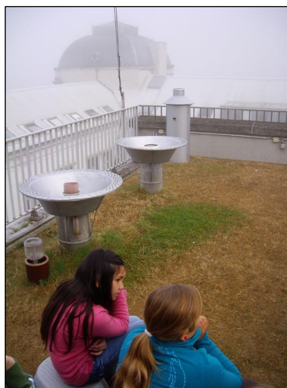
Afbeelding 42: de elektronische en analoge pluviometer op de voorgrond, met de pluviograaf op de achtergrond, op een mistige dag.
